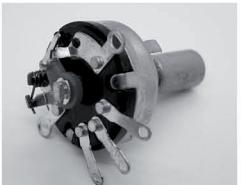
Réglage du volume avec interrupteur et réglage de rétroaction (potentiomètres)
